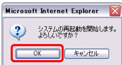
主装置が再起動した後、接続しているIP多機能電話機、IPコードレス電話機の自動バージョンアップを行います。起動完了するまでに約15分かかります。起動完了までの時間は接続している電話機の台数により、異なります。
