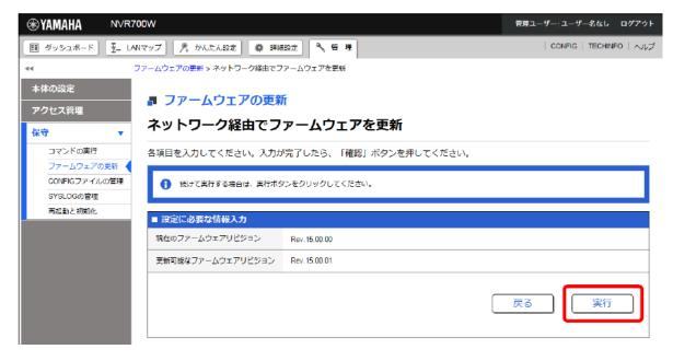
「ファームウェアの更新」ダイアログが表示され、ファームウェアの更新が開始されます。ファームウェアの更新が完了すると、ルータは自動的に再起動します。
