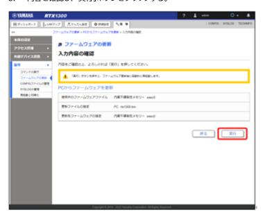
「ファームウェアの更新」ダイアログが表示され、ファームウェアの更新が開始されます。ファームウェアの更新が完了すると本ルータは自動的に再起動します。
