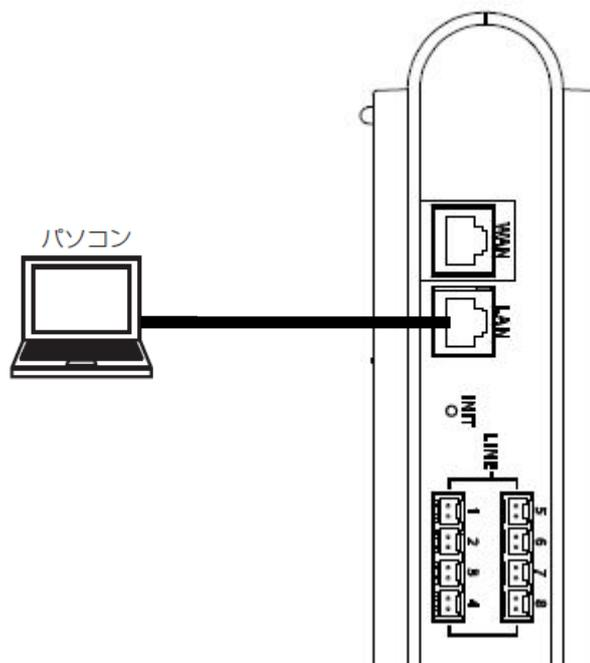
図は、VG830a 装置である。他 VG でも同様の接続を行う。
