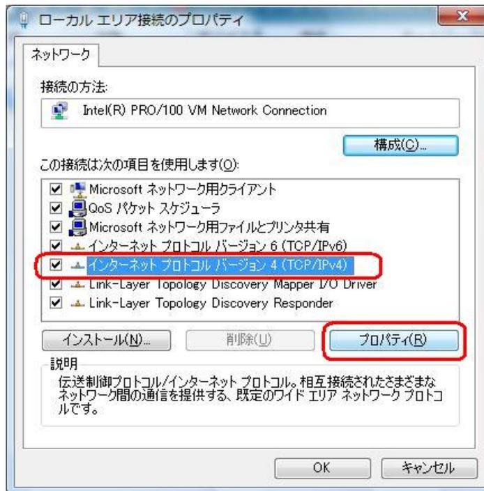
[次の IP アドレスを使う]にチェックを入れ、IP アドレス、サブネットマスクを入力した後、[OK]をクリックします。
