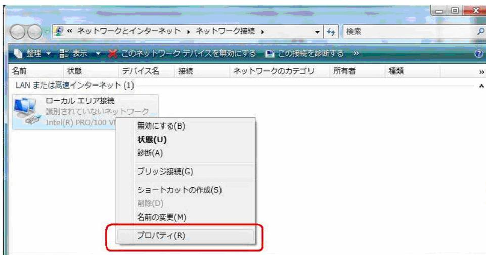
[インターネットプロトコル バージョン 4(TCP/IPv4)]を選択し、[プロパティ]をクリックします。
