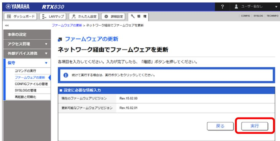
「ファームウェアの更新」ダイアログが表示され、ファームウェアの更新が開始されます。ファームウェアの更新が完了すると、本ルーターは自動的に再起動します。
