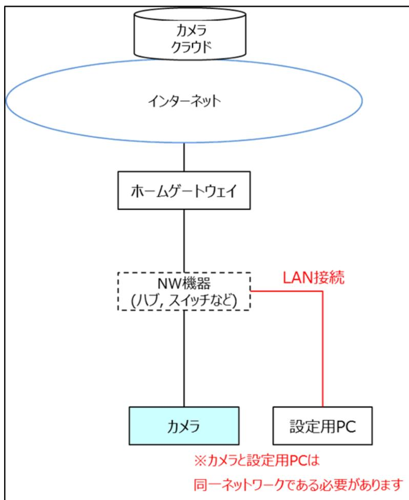
※ハブ・スイッチ等をご利用でない場合は、同一のホームゲートウェイの LAN ポートに、カメラと設定用 PC を有線 (LAN ケーブル) 接続してください。
