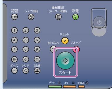
コピーが終了したあと、操作パネルの〈リセット〉ボタンを押せば設定した項目を初期状態に戻せます。
