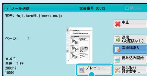
チェックを付けておくと、原稿（原稿の束）の読み込みが終了したあとに、原稿のプレビュー画像を確認できます。なお、[プレビュー] にチェックを付けると、次のようなメッセージが表示されます。各項目を設定してから [スタート] ボタンを押してください。
