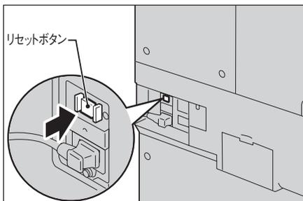
6. ボールペンなどの先のとがったもので、テストボタンを軽く押します。押し込まれていた〈リセット〉ボタンが解除され、突き出ます。これで確認は終了です。
