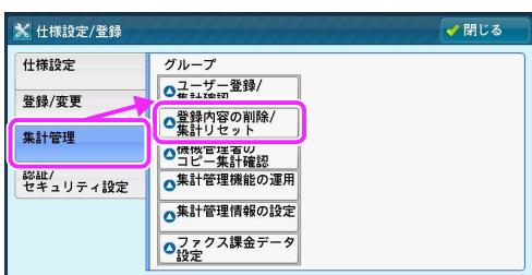
**5** 削除したいデータを選択し、[削除 / リセット] を押します。
