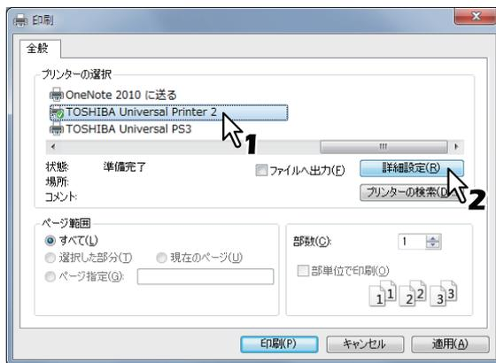
プリンタのプロパティダイアログボックスが表示されます。
