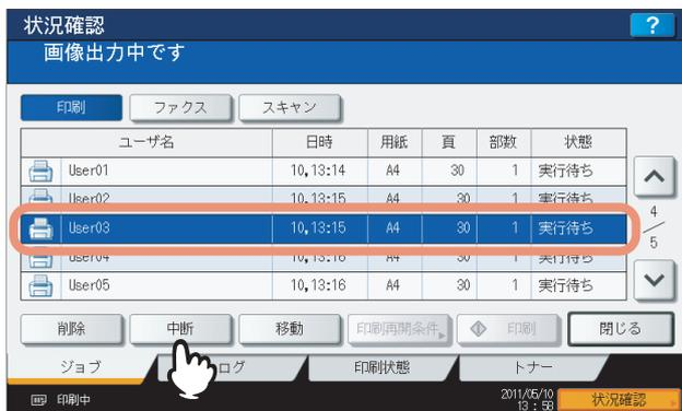
選択したジョブが中断されます。ジョブを中断すると、次のジョブが先に実行されます。
