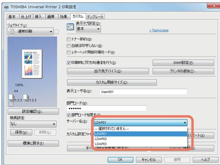
LDAPサーバーを指定せずに印刷ジョブを送信すると、[LDAPサーバー選択] ダイアログボックスが表示され、サーバーの指定が要求されます。
