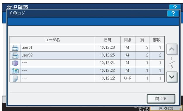
印刷ログ画面では、ジョブを送ったユーザ名、印刷した日時、用紙サイズ、ページ数および部数が表示されます。最大1000件の履歴が表示されます。本機にハードディスクが装着されていない場合は、最大100件の履歴が表示されます。
