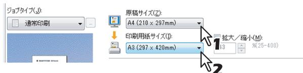
選択した原稿および用紙のサイズに応じて、ページイメージが変倍されます。
