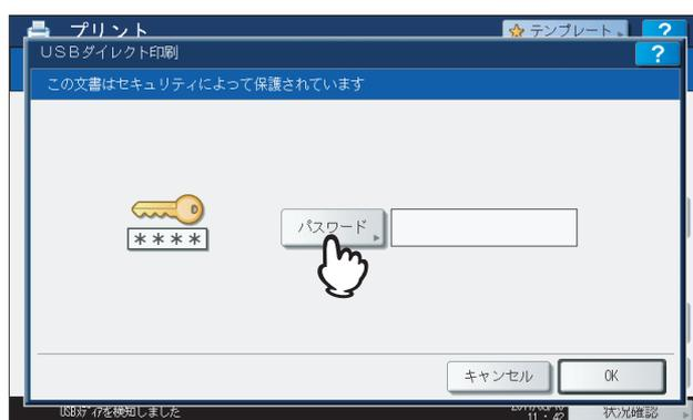
7 文字入力画面およびテンキーを使って、暗号化PDFファイルのユーザパスワード（1～32桁）またはマスタパスワードを入力し、[OK] を押します。
