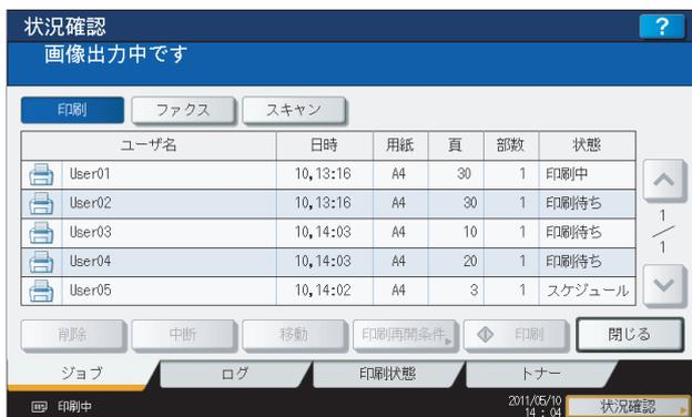
予約印刷ジョブは、「状態」の欄に「スケジュール」と表示されます。
