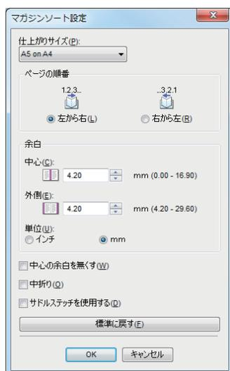
**A5 on A4** : 各ページをA5サイズに縮小し、A4サイズの内紙に2ページずつ印刷します。
