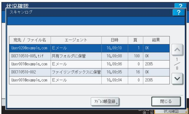
ログ画面には、各ジョブの宛先/ファイル名、エージェント(スキャン機能)、登録日時、ページ数、実行結果が表示されます。最大1000件の履歴が表示されます。前後のページを表示するには、**[▲]** または **[▼]** を押してください。1ページに表示されるジョブの数は、お使いの機種により異なります。
