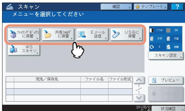
**[ファイリングボックスに保管]**：スキャンした画像データをファイリングボックスに保存します。
