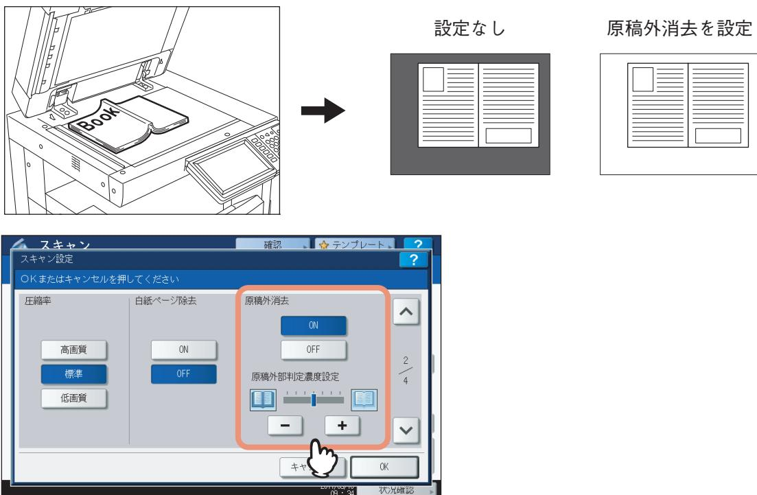
**[ON]**：原稿外消去機能を有効にします。ボタンを押すと、「原稿外部判定濃度設定」のスライダが有効になります。
