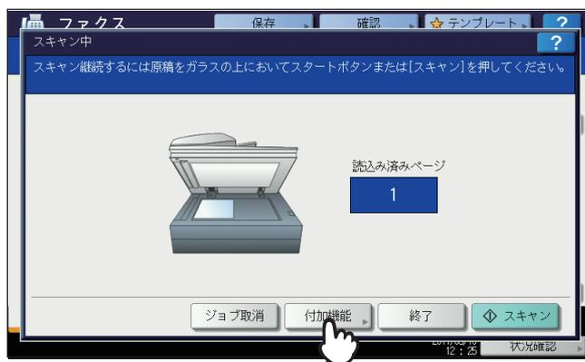
上図は、原稿ガラスへ原稿をセットした場合の例です。自動両面原稿送り装置へ原稿をセットした場合は、読み取りの途中で「継続」を押すと、読み取り完了後に次原稿の確認画面が表示されます。また、読み取りの途中で操作パネルの「ストップ」ボタンを押すと、読み取りを中断して次原稿の確認画面を表示することができます。
