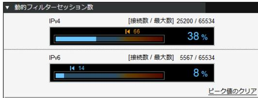
動的フィルターで管理しているセッション数が表示されます。メーターの右側の数字は現在の使用率を示し、上部はピークの使用率を示します。メーターの上部に現在の接続数と最大数が表示されます。
