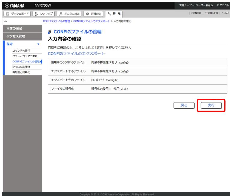
「CONFIG ファイルのエクスポート」ダイアログが表示され、外部メモリに CONFIG ファイルがエクスポートされます。
