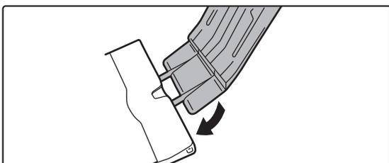
手差しトレイの補助ガイドに長尺紙用ガイドをセットする
