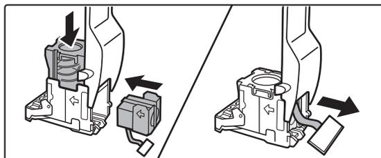
図のように新しい針カートリッジを針ケースにセットする
