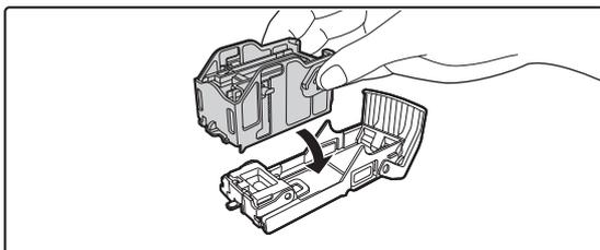
図のように新しい針カートリッジを針ケースにセットする
