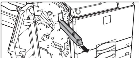
パンチくず回収箱を静かに手前に引き抜き、パンチくずを取り除く
