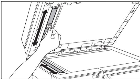
原稿台側の原稿読み取り部をガラスクリーナーで清掃する
