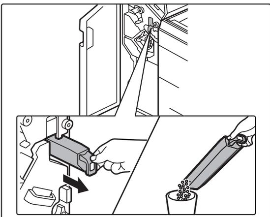
パンチくず回収箱を静かに手前に引き抜き、パンチくずを取り除く
