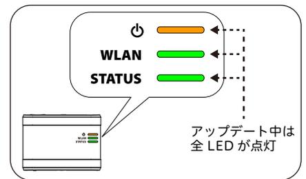
**7** 本製品上面の全 LED が、同時に点灯以外の状態になったら、ファームウェアのアップデートは完了です。
