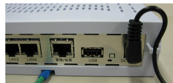
図③ 電源コード固定状態
