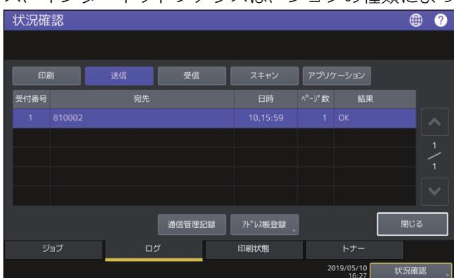
ログ画面には、ジョブの種類を表すアイコン、ジョブを実行したユーザ名、印刷した日時、用紙サイズ、ページ数、部数が表示されます。送信履歴または受信履歴画面で、表示されている履歴を印刷する場合は、[通信管理記録] を押してください。
