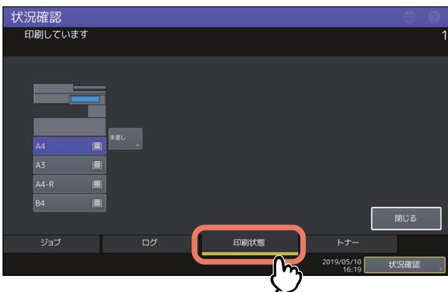
印刷中は、給紙しているカセットが反転表示されます。
