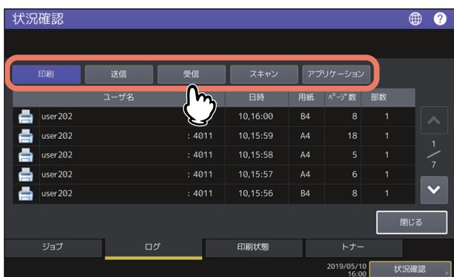
ログ画面が表示されます。コピージョブは、印刷ジョブとともに印刷ログ画面に表示されます。ファクス、インターネットファクスは、ジョブの種類によって送信と受信が別々に表示されます。
