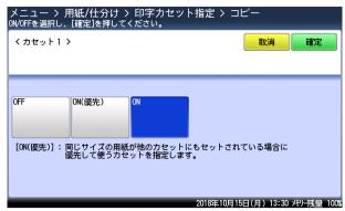
・OFF: この給紙カセットにセットされている用紙を使用しない。・ON: この給紙カセットにセットされている用紙を使用する。
