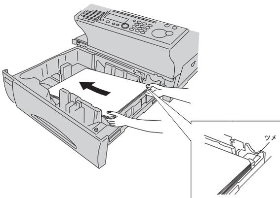
**4** 用紙ガイド横をセットした用紙の幅に合わせて調整します。
