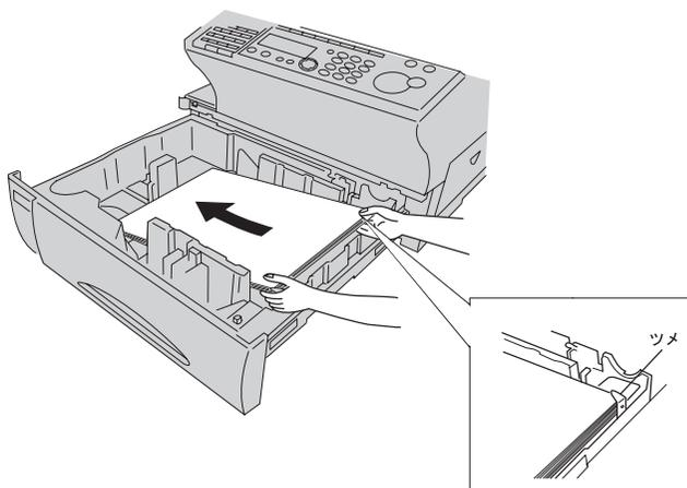
**8** 用紙ガイド横をセットした用紙の幅に合わせて調節します。
